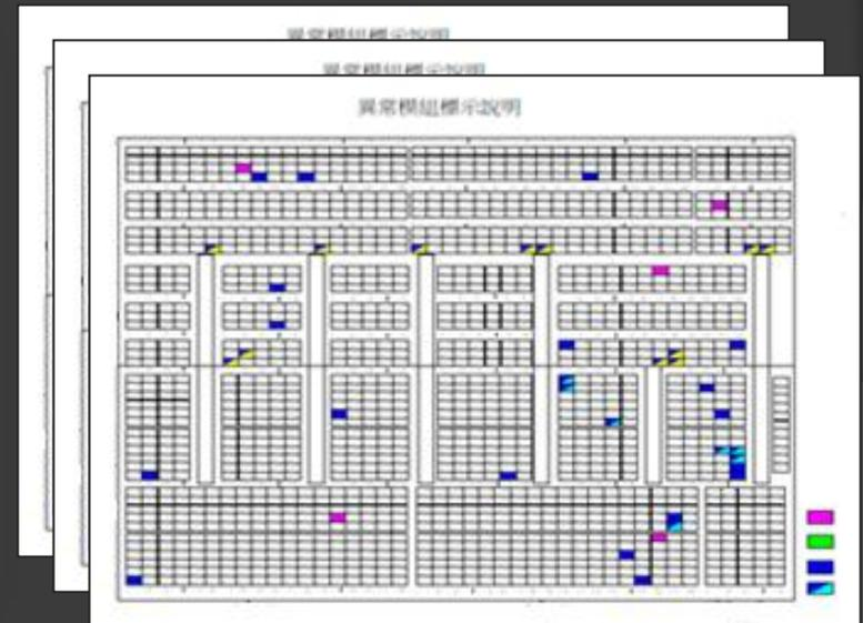
(範例: 以不同顏色標示不同缺陷在電站配置圖中的位置)
