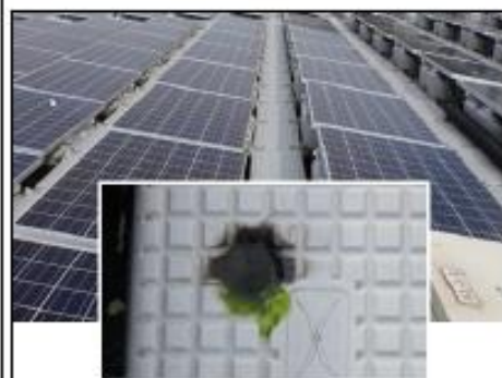
直流配線が断線時のフロート焼損痕 (対策作業中)
