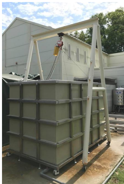
內層為耐腐蝕PP板。
