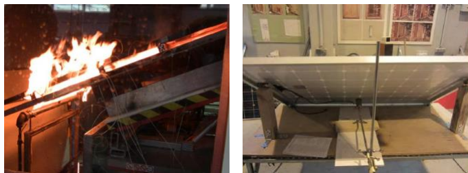
從模組下方點火測試
