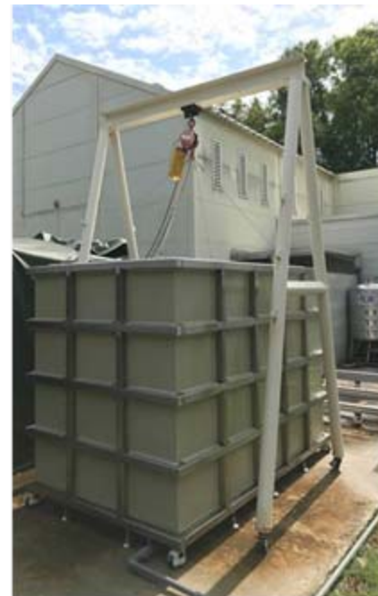
IP X8 防水試驗箱系統建置 內層為耐腐蝕PP板。
